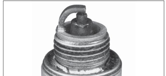
Eine nasse Zündkerze ist das Ergebnis von zu viel Kraftstoff oder Öl im Brennraum. Überschüssiger Kraftstoff kann durch einen verstopften Luftfilter, ein Vergaserproblem oder den Betrieb des Motors mit zu viel Choke verursacht sein. Öl im Brennraum wird normalerweise durch einen verstopften Luftfilter, ein Entlüfterproblem oder durch verschlissene Kolbenringe oder Ventildführungen verursacht.
